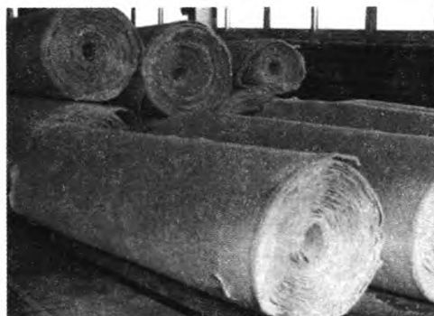
图2 木纤维复合材料卷材
